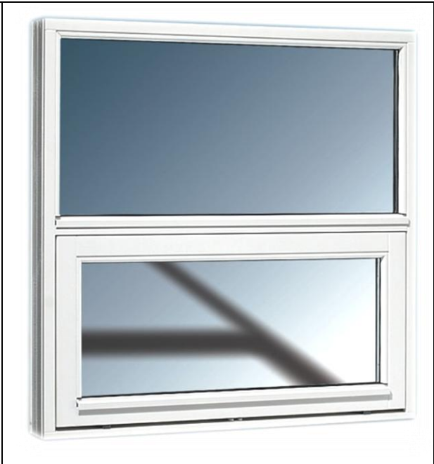
2 gløs, ovara fast og niðara toppstýrt. (sí munin millum toppstýrt og toppsving á síðu 4 )
